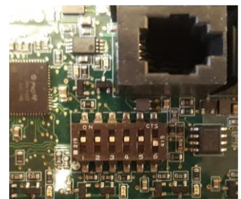
Abbildung 4 DIP-Schalterstellungen für den Betrieb eines Saunaheizgerät.
