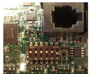
Imagen 4 Posiciones del interruptor DIP para usar un calentador
